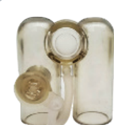
2400/5J Conector Jackson com furo do termômetro autoclavável
