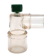
2400/90L Conector 22macho x 15macho 90° autoclavável com Luer Lock
